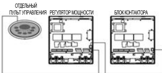
Рис.7 Установка отдельного пульта управления с регулятором мощности и блоком контактора
